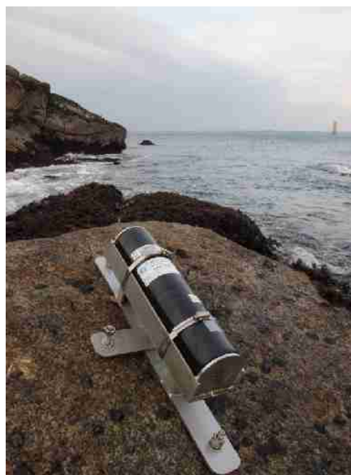
Capteur de niveau d'eau installé en bas de grève
